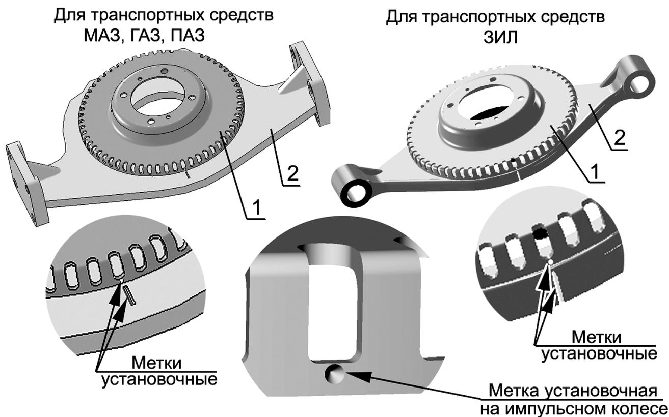
1 – колесо импульсное (конструктивное исполнение– б); 2 – опора передняя.
