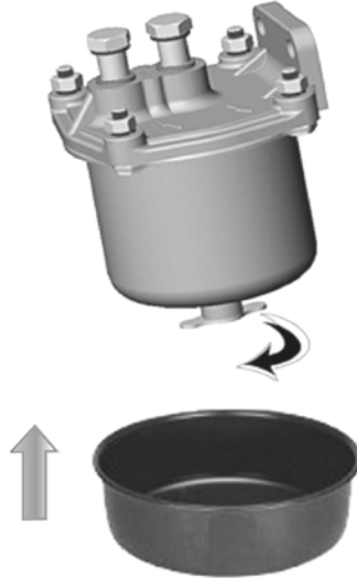
Рисунок 26 – Слив отстоя из фильтра грубой очистки топлива.
