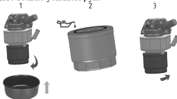
Рисунок 24 – Замена масляного фильтра
