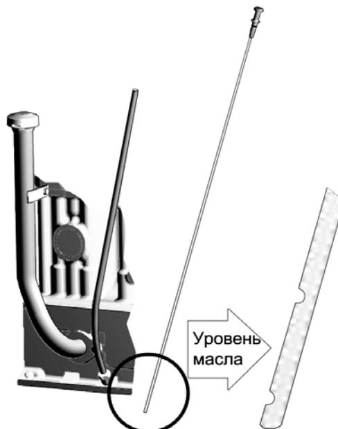
Рисунок 26- Проверка уровня масла в картере дизеля.
