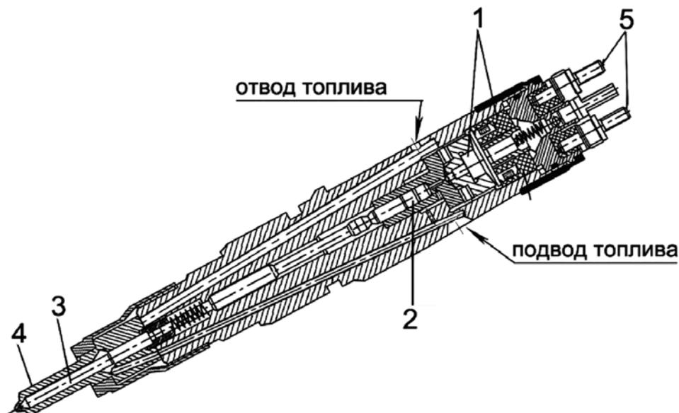
1 – электромагнитный клапан; 2 – управляющий поршень; 3 – игла распылителя; 4 – корпус распылителя; 5 – клеммы.
