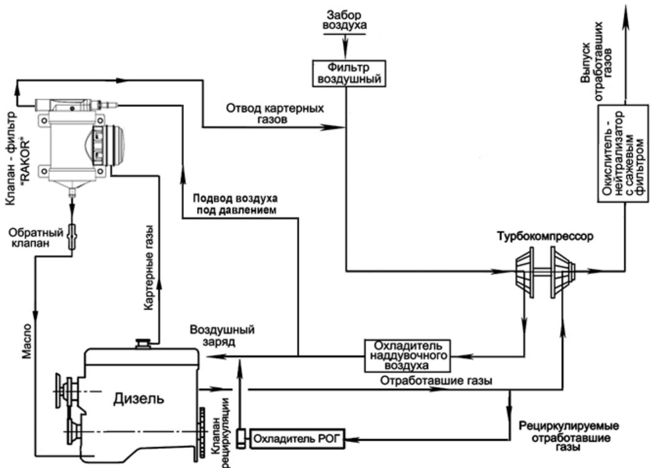
Рисунок 146 – Схема газообмена дизеля Д-245.35Е4
