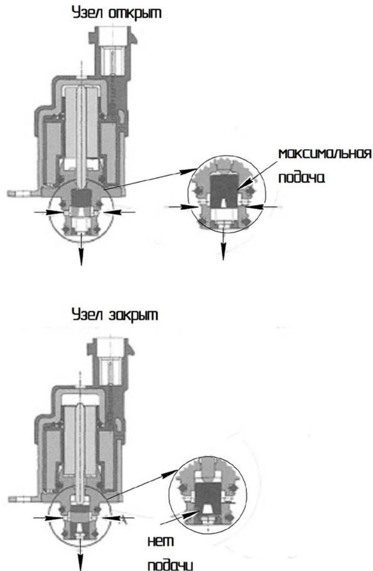
Рисунок 6 а – Регулятор давления топлива
