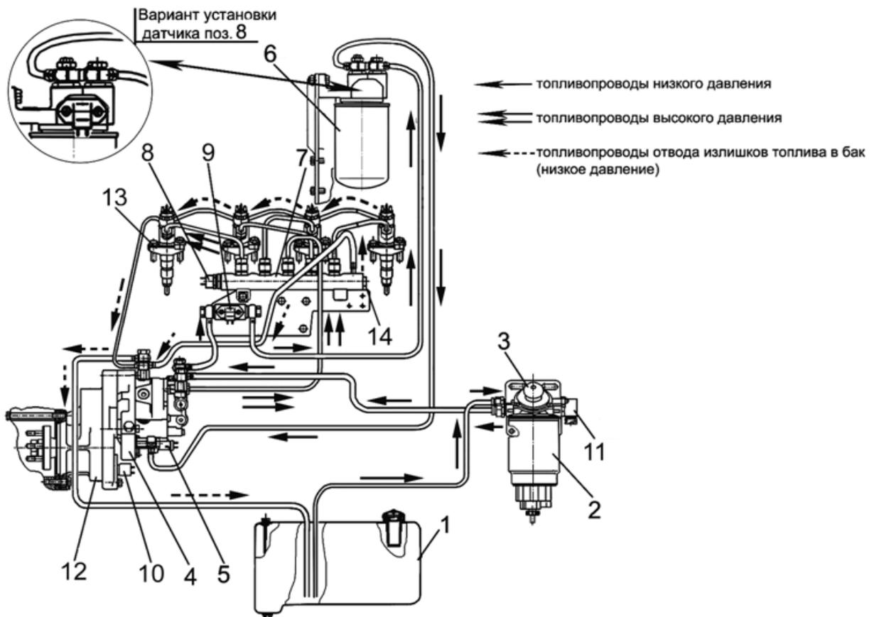
1 - топливный бак; 2 - фильтр предварительной очистки топлива; 3- ручной топливонакачивающий насос; 4\* - топливный насос высокого давления СРЗ.3; 5 - регулятор давления; 6 - фильтр тонкой очистки топлива 7 - аккумулятор топлива под высоким давлением; 8 - датчик высокого давления топлива; 9 - датчик температуры и давления топлива; 10 - датчик частоты вращения распределительного вала; 11 - подогреватель топлива; 12\*\* - редуктор привода ТНВД; 13 - форсунка; 14 - клапан ограничения давления.
