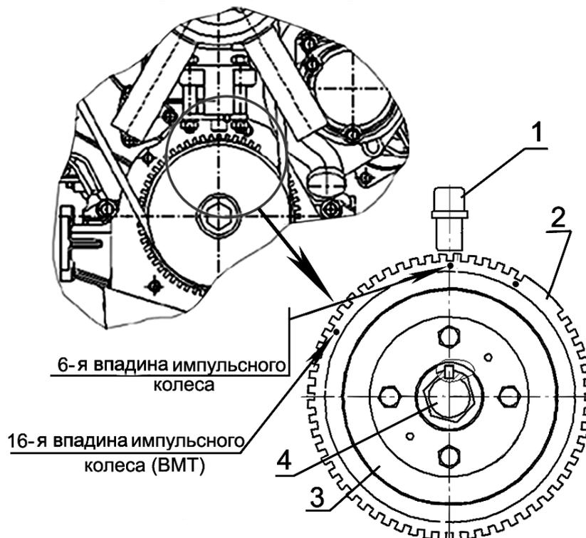
1 – датчик частоты вращения коленчатого вала; 2 – колесо импульсное; 3 - шкив коленчатого вала; 4 – болт крепления шкива.
