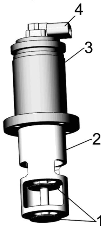
1 – клапан; 2 – корпус клапана; 3 – электромагнит; 4 – штекерный разъем;
