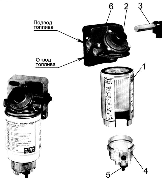
1 – фильтр грубой очистки топлива; 2 – ручной топливоподкачивающий насос; 3 – подогреватель топлива; 4 – влагосборник; 5 – кран выпуска воды; 6 – пробка для выпуска воздуха.
