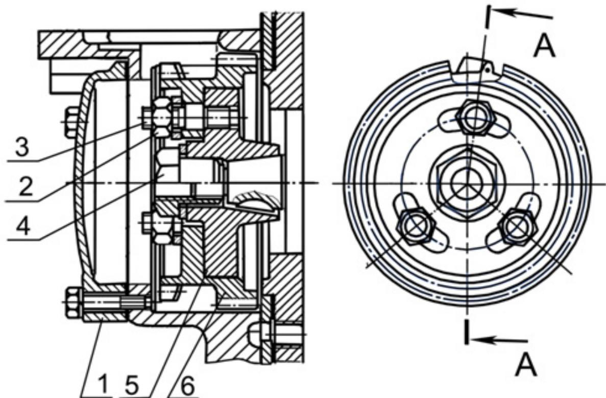
1 – крышка люка; 2 – гайка и шайба; 3 – шпилька; 4 – гайка специальная; 5 – полумуфта привода; 6 – шестерня привода редуктора
