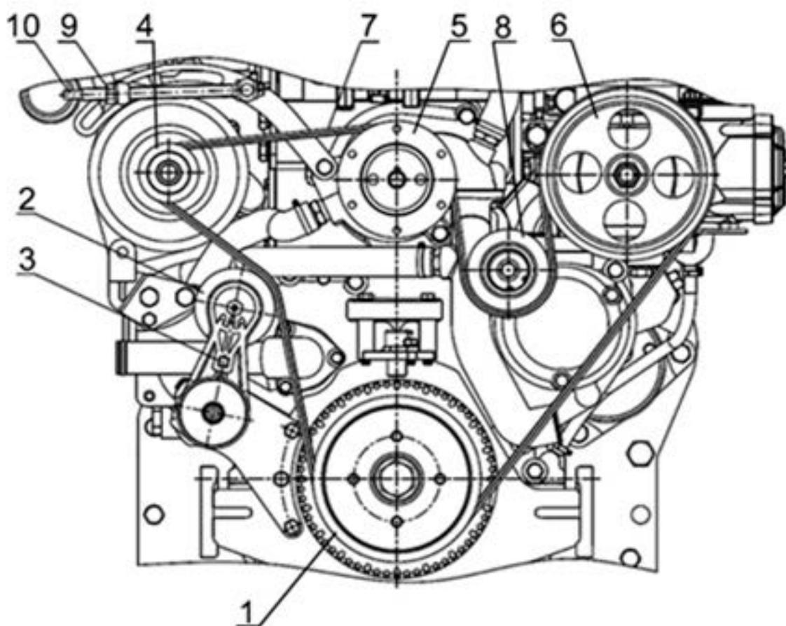
1 – шкив коленчатого вала; 2 – ролик механизма натяжения ремня; 3 – отверстие под стопор механизма натяжения; 4 – шкив генератора; 5 – шкив водяного насоса; 6 – шкив компрессора; 7 – ремень поликлиновой; 8; 11(Д-245.7E4) – ролик обводной; 9 – болт натяжителя; 10 – гайка.
