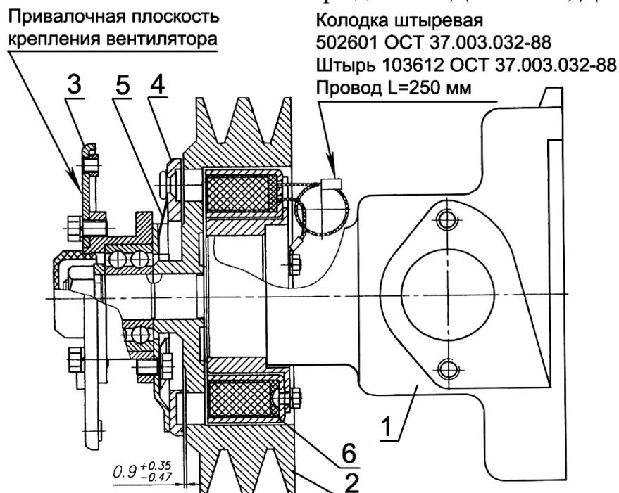
1 – водяной насос; 2 – шкив; 3 – диск с корпусом; 4 – диск прижимной; 5 – пружина пластинчатая; 6 – электромагнит.
