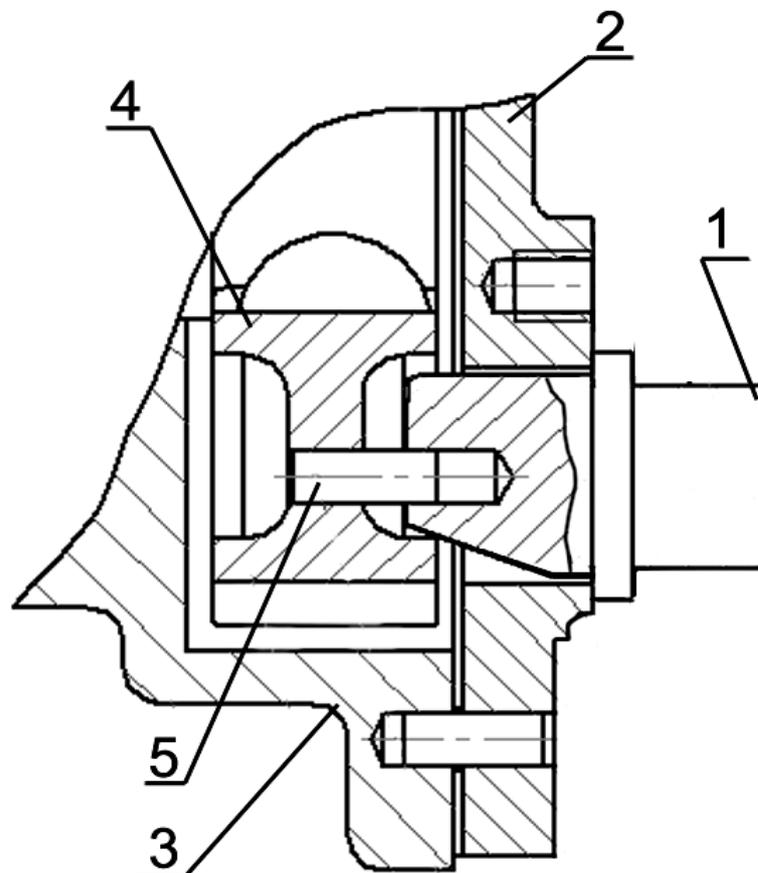
1 – приспособление для фиксации установочного штифта; 2 – крышка редуктора; 3 - корпус редуктора; 4 – шестерня; 5 – штифт установочный.
