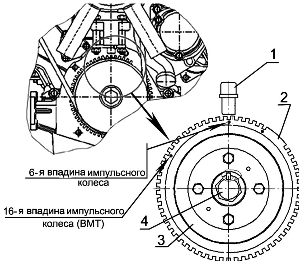
1 – датчик частоты вращения коленчатого вала; 2 – колесо импульсное; 3 - шкив коленчатого вала; 4 – болт крепления шкива.
