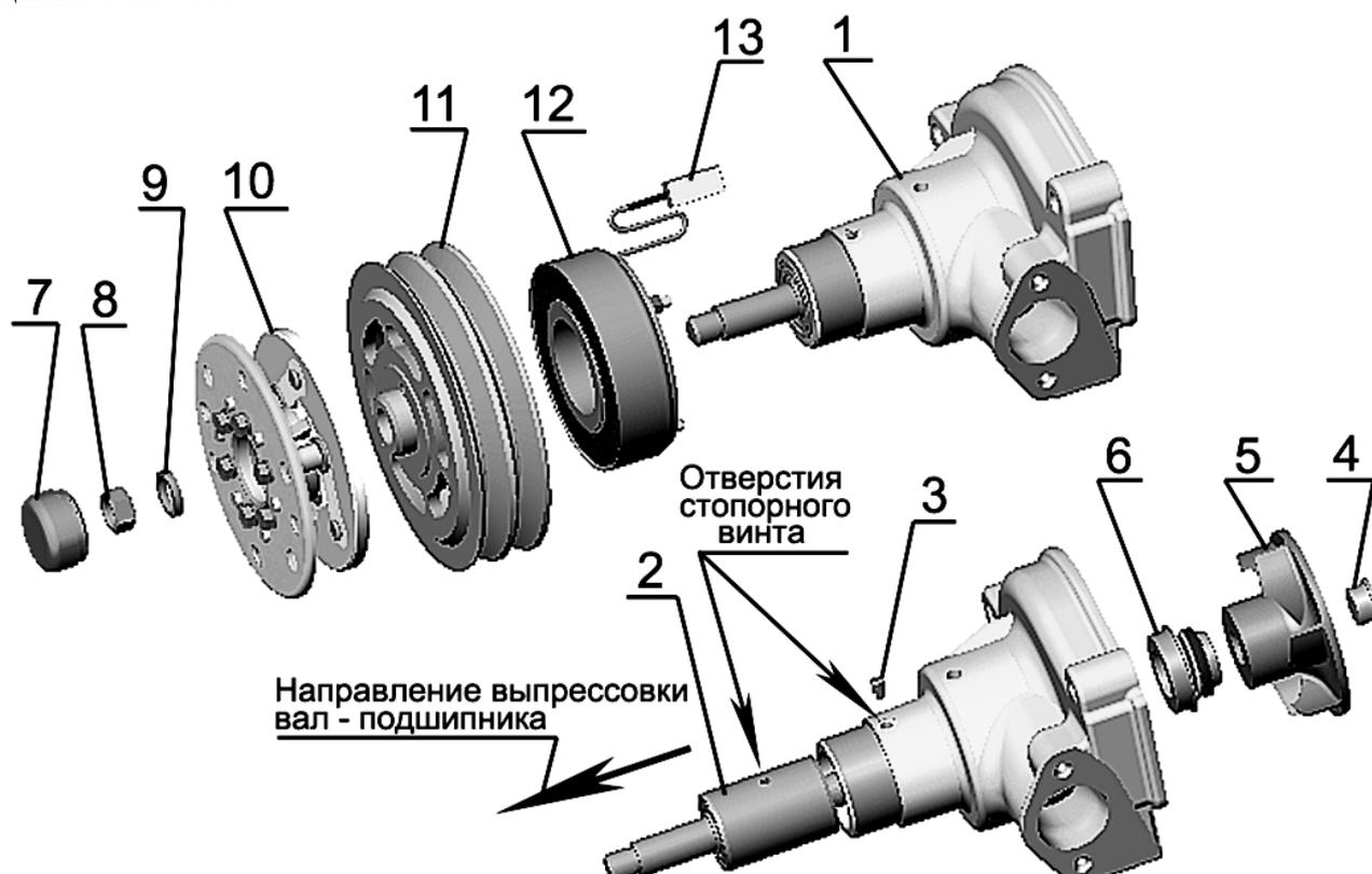
1 – корпус; 2 – вал-подшипник; 3 – винт стопорный; 4 – заглушка; 5 – крыльчатка; 6 – уплотнение водяного насоса SP/1341; 7 – колпачек; 8 – гайка; 10 – корпус вентилятора; 11 – шкив; 12 – электромагнит с фланцем; 13 – штекерный разъем.
