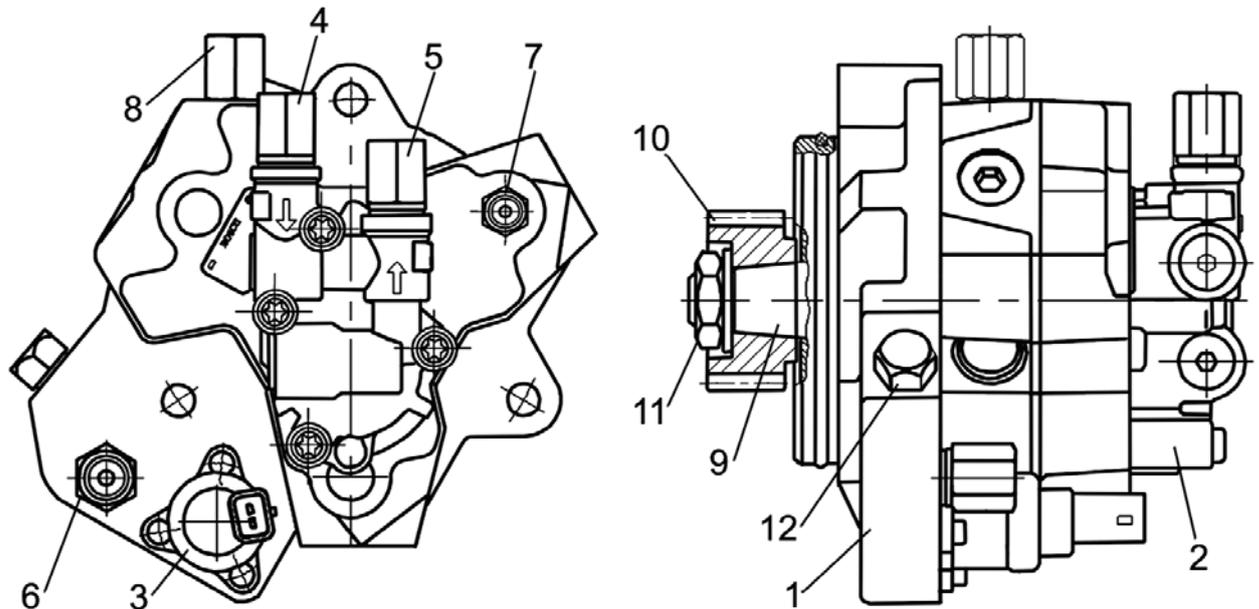
1 – топливный насос высокого давления; 2 – топливоподкачивающий насос; 3 – регулятор давления; 4 – штуцер подвода топлива от фильтра грубой очистки топлива; 5 – штуцер отвода топлива к топливному фильтру тонкой очистки; 6 – штуцер подвода топлива от топливного фильтра тонкой очистки; 7 – штуцер отвода топлива к аккумулятору топлива; 8 – штуцер отвода топлива в бак; 9 – вал привода; 10 – шестерня привода; 11 – гайка; 12 – защитный клапан с дроссельным отверстием.
