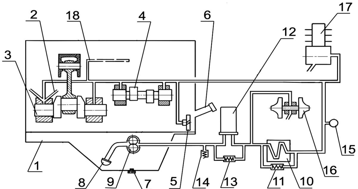
1 - картер масляный; 2 - форсунки охлаждения поршней; 3 - вал коленчатый; 4 - вал распределительный; 5 - шестерня промежуточная; 6 - горловина маслозаливная; 7 - пробка масляного картера; 8 - маслоприемник; 9 - насос масляный; 10 - радиатор масляный; 11 - клапан редукционный; 12 - фильтр масляный; 13 - клапан перепускной; 14 - клапан предохранительный; 15 - датчик давления; 16 - турбокомпрессор; 17 - компрессор; 18 - масляный канал оси коромысел,
