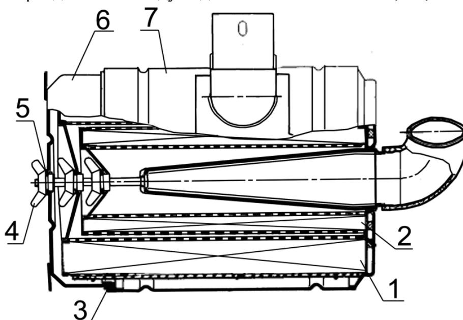
1 – элемент фильтрующий основной; 2 – элемент фильтрующий контрольный; 3 – прокладка; 4 – гайка-барашек; 5 – кольцо; 6 – поддон; 7 – корпус.
