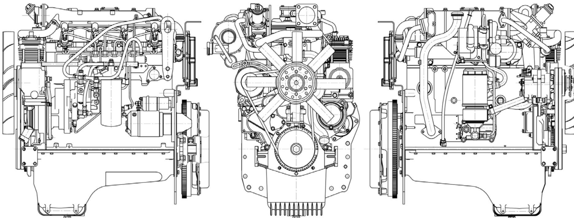
Рисунок 1а – Общий вид дизеля Д-245.7Е4
