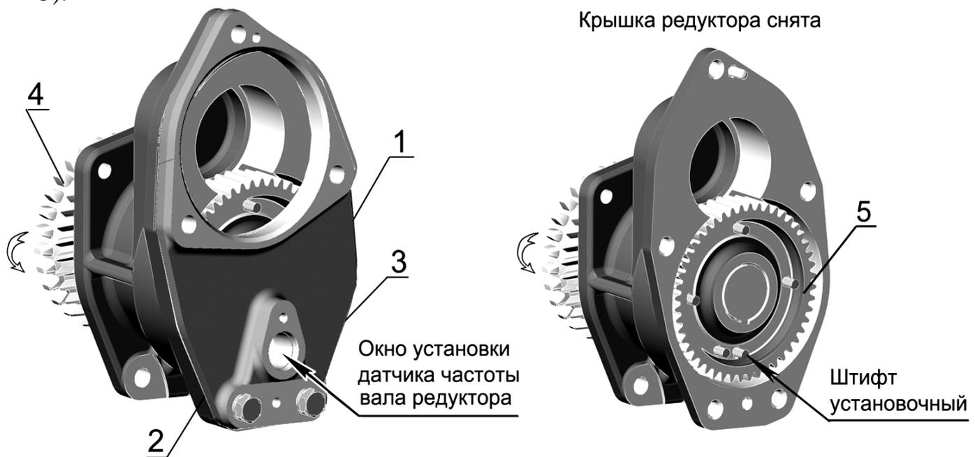
1 – редуктор привода ТНВД; 2 – установочный фланец датчика; 3 – болт крепления фланца; 4 – шестерня привода редуктора; 5 – шестерня с импульсными штифтами.
