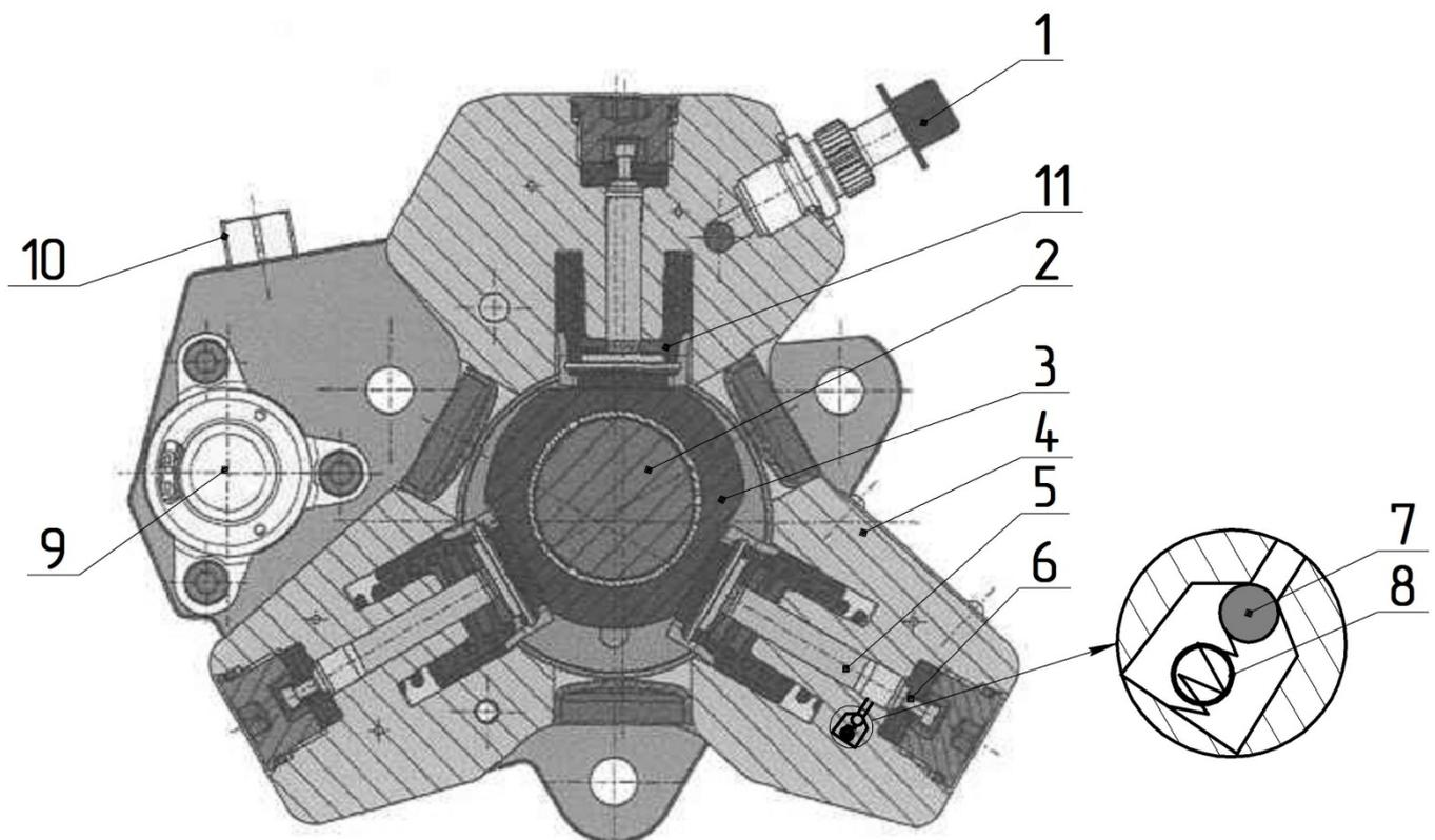
1 – штуцер нагнетательный; 2 – эксцентрик кулачкового вала; 3 – ползун; 4 – корпус ТНВД; 5 – плунжер; 6 – клапан наполнительный; 7 – клапан нагнетательный; 8 – канал подачи топлива в аккумулятор; 9 – регулятор давления; 10 – клапан перепускной; 11 – толкатель.
