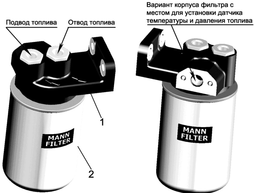
1 – корпус фильтра; 2 – фильтр тонкой очистки топлива Mann & Hummel WDK962 (Германия).
