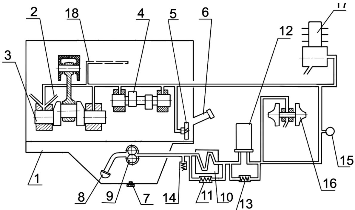
1 – картер масляный; 2 – форсунки охлаждения поршней; 3 – вал коленчатый; 4 – вал распределительный; 5 – шестерня промежуточная; 6 – горловина маслозаливная; 7 – пробка масляного картера; 8 – маслоприемник; 9 – насос масляный; 10 – жидкостно-масляный теплообменник (ЖМТ); 11 – клапан перепускной; 12 – фильтр масляный; 13 – клапан перепускной; 14 – клапан предохранительный; 15 – датчик давления; 16 – турбокомпрессор; 17 – компрессор; 18 – масляный канал оси коромысел.
