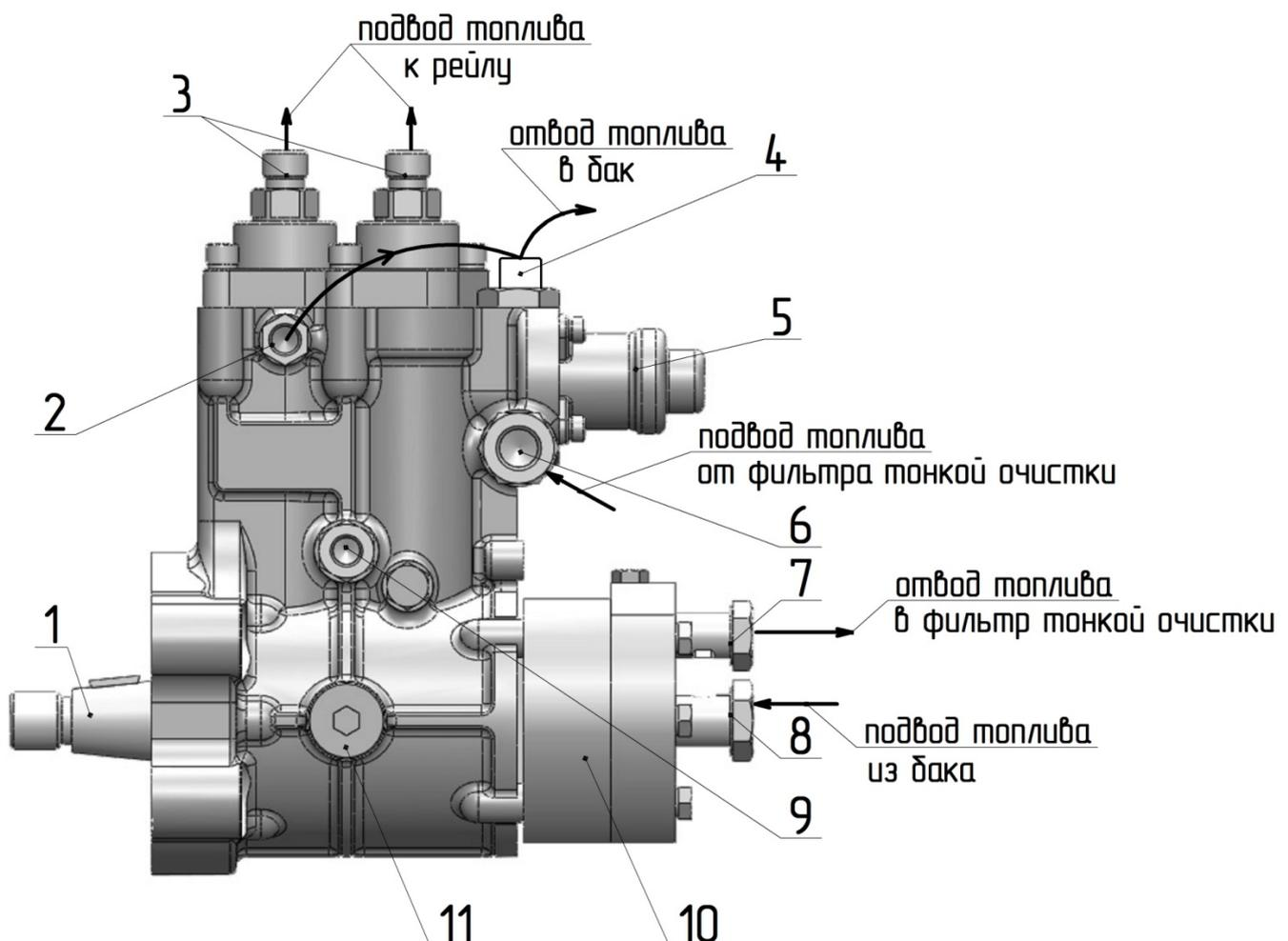
1 – вал насоса; 2 – штуцер перепуска топлива в бак; 3 – штуцеры подвода топлива к рейлу; 4 – штуцер перепуска топлива в бак с обратным клапаном; 5 – электромагнитный клапан дозирования подачи топлива; 6 – штуцер подвода топлива от фильтра тонкой очистки; 7 – штуцер отвода топлива в фильтр тонкой очистки; 8 – штуцер подвода топлива из бака; 9 – штуцер подвода масла из системы смазки двигателя; 10 – топливоподкачивающий насос; 11 – пробка для заливания масла в насос.
