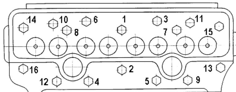
Рисунок 37 - Схема последовательности затяжки болтов крепления головки цилиндров
