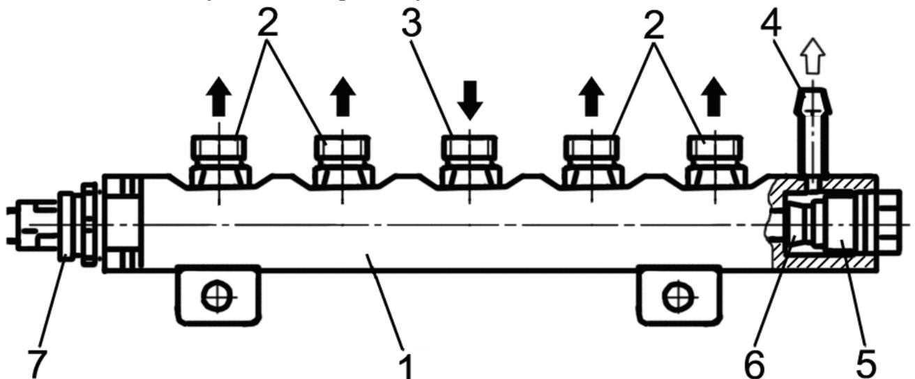
1 – аккумулятор топлива под высоким давлением; 2 – штуцеры отводящие; 3 – штуцер подводящий; 4 – штуцер обратного слива; 5 – клапан ограничения давления; 6 – запорный конус сердечника клапана; 7 – датчик давления топлива.
