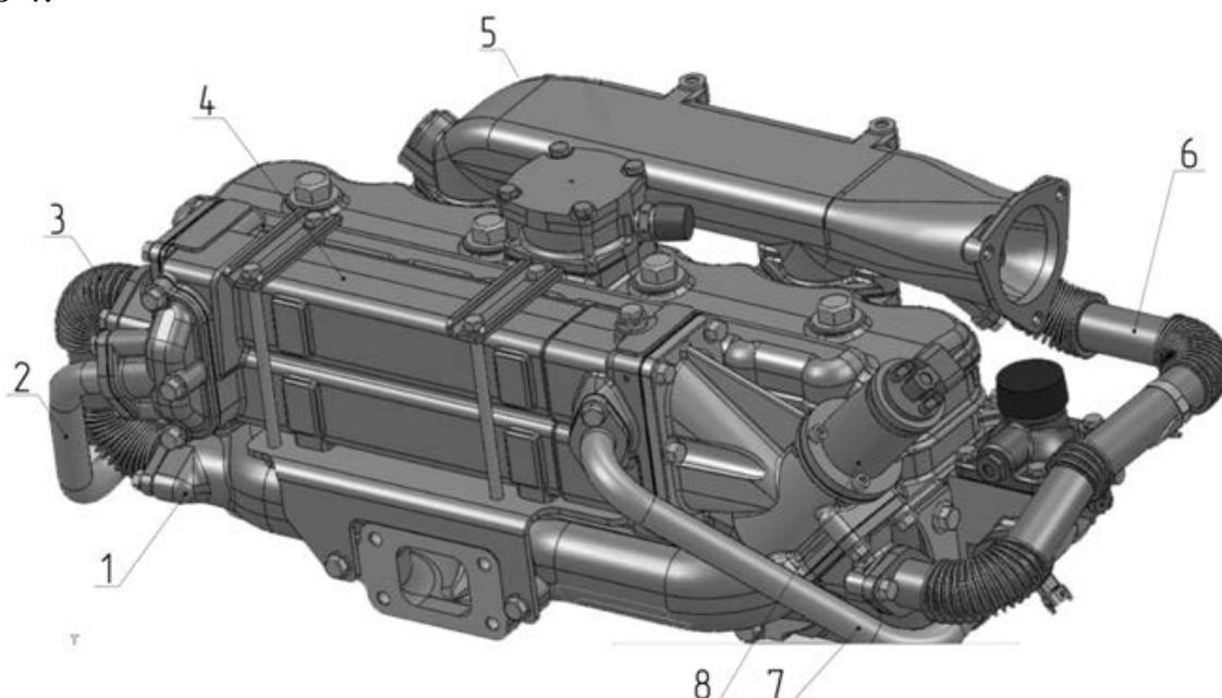
1 – коллектор выпускной; 2 – патрубок подвода охлаждающей жидкости к охладителю РОГ; 3 – патрубок подвода выпускных газов к охладителю РОГ; 4 – охладитель РОГ; 5 – впускной коллектор; 6 – патрубок подвода охлажденных; 7 - патрубок отвода охлаждающей жидкости от охладителя РОГ рециркулируемых газов к впускному коллектору; 8 – клапан рециркуляции.
