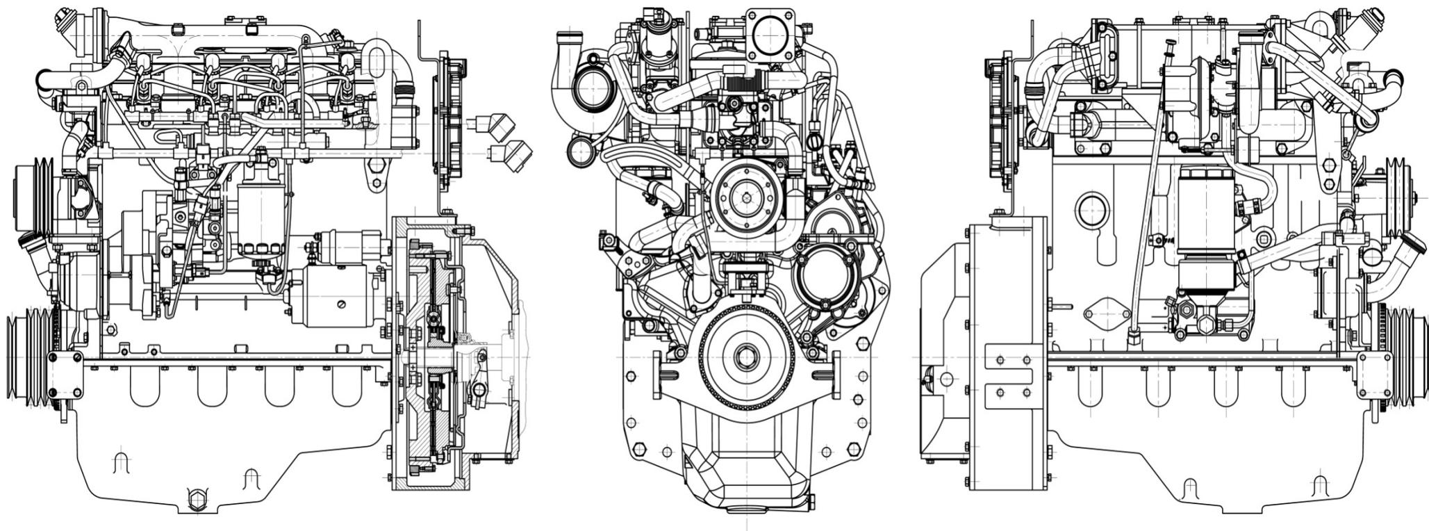
Рисунок 1б – Общий вид дизеля Д-245.9Е4
