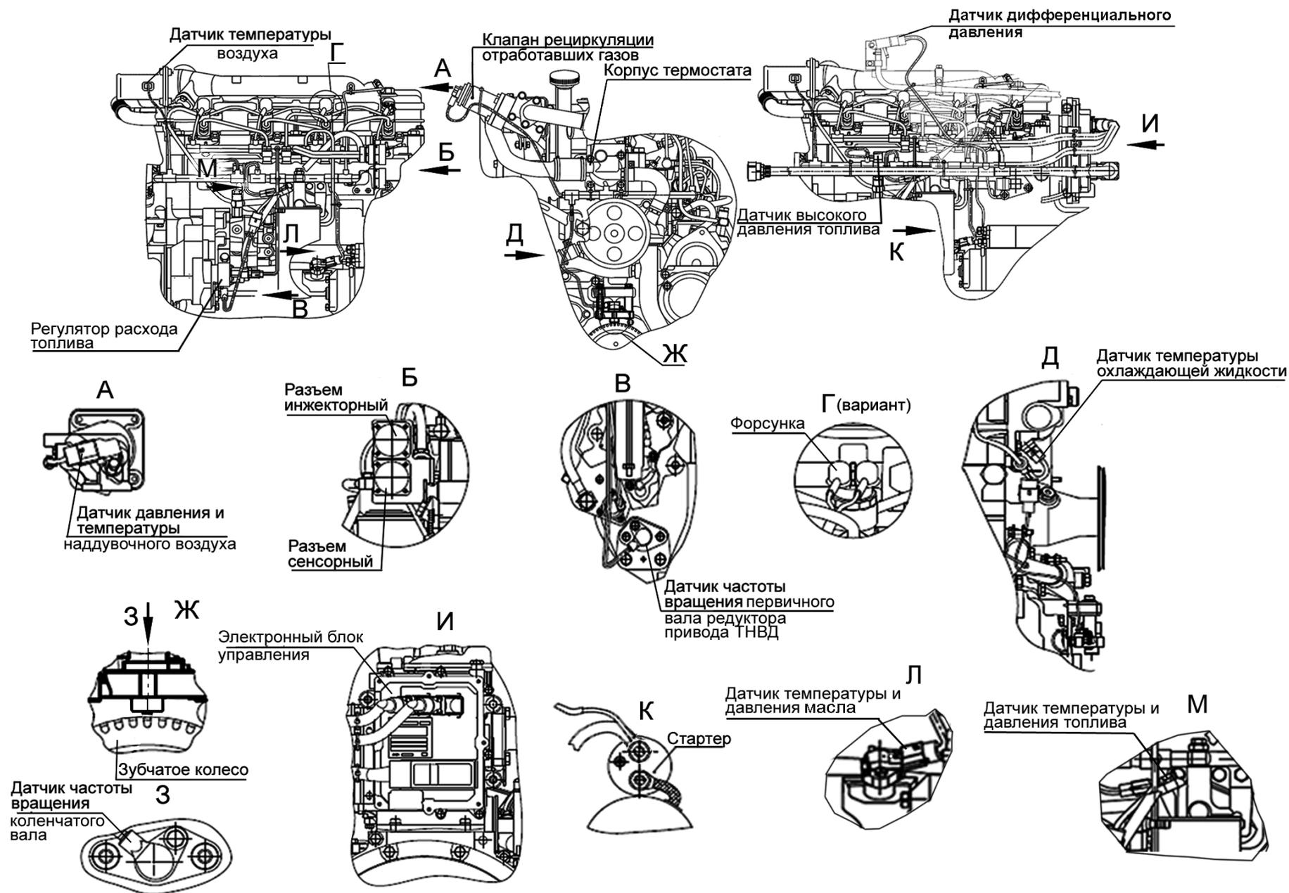
Рисунок 13 - Схема расположения компонентов электронной системы управления
