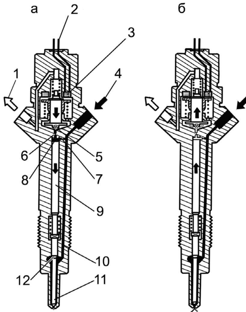
1 – магистраль обратного слива топлива; 2 – клеммы электрического подсоединения; 3 – электромагнитный клапан; 4 – магистраль высокого давления; 5 – шарик клапана; 6 – дроссельное отверстие отвода топлива; 7 – дроссельное отверстие подачи топлива; 8 – камера управляющего клапана; 9 – поршень, управляющий клапаном; 10 – канал подвода топлива к распылителю; 11 – распылитель (игла и корпус); 12 – фаска (заплечик) иглы распылителя.
