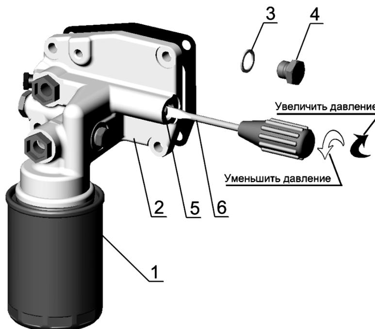
1 – фильтр масляный; 2 – корпус масляного фильтра; 3 – прокладка пробки; 4 – пробка клапана; 5 – пробка регулировочная; 6 – отвертка;
