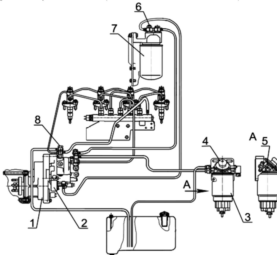
1- редуктор; 2 - насос топливный; 3 – фильтр грубой очистки топлива; 4 – ручной подкачивающий насос; 5 – пробка для выпуска воздуха; 6 – болт поворотного угольника; 7 – фильтр топливный тонкой очистки; 8 – болт поворотного угольника.
