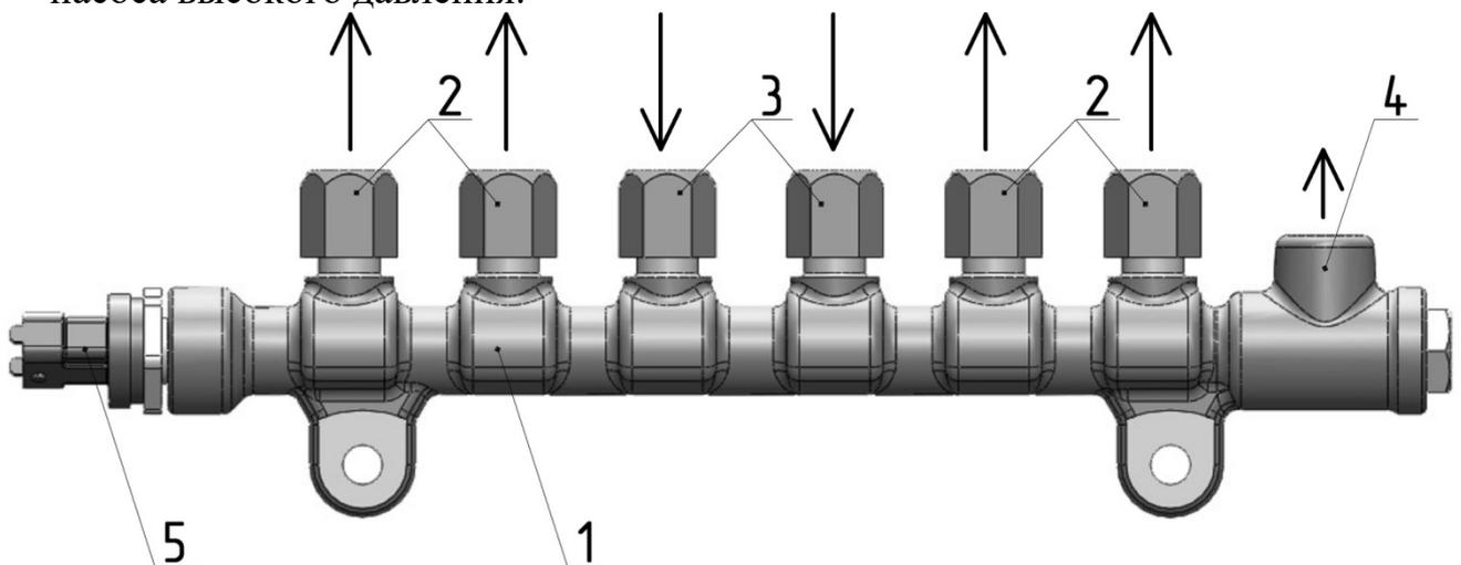
1 – аккумулятор топлива под высоким давлением; 2 – штуцеры отводящие; 3 – штуцеры подводящие; 4 – штуцер обратного слива; 5 – датчик давления топлива.
