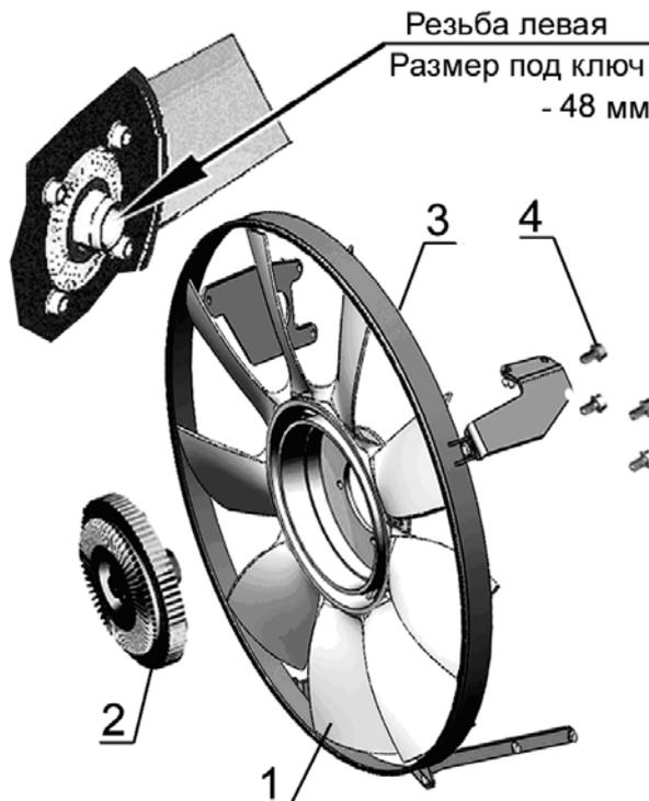
1 – вентилятор; 2 – вязкостная муфта; 3 – направляющий аппарат; 4 – болт.
