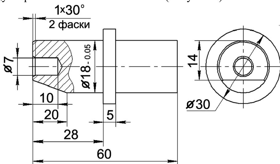
Рисунок 1 – Приспособление для фиксации импульсного венца
