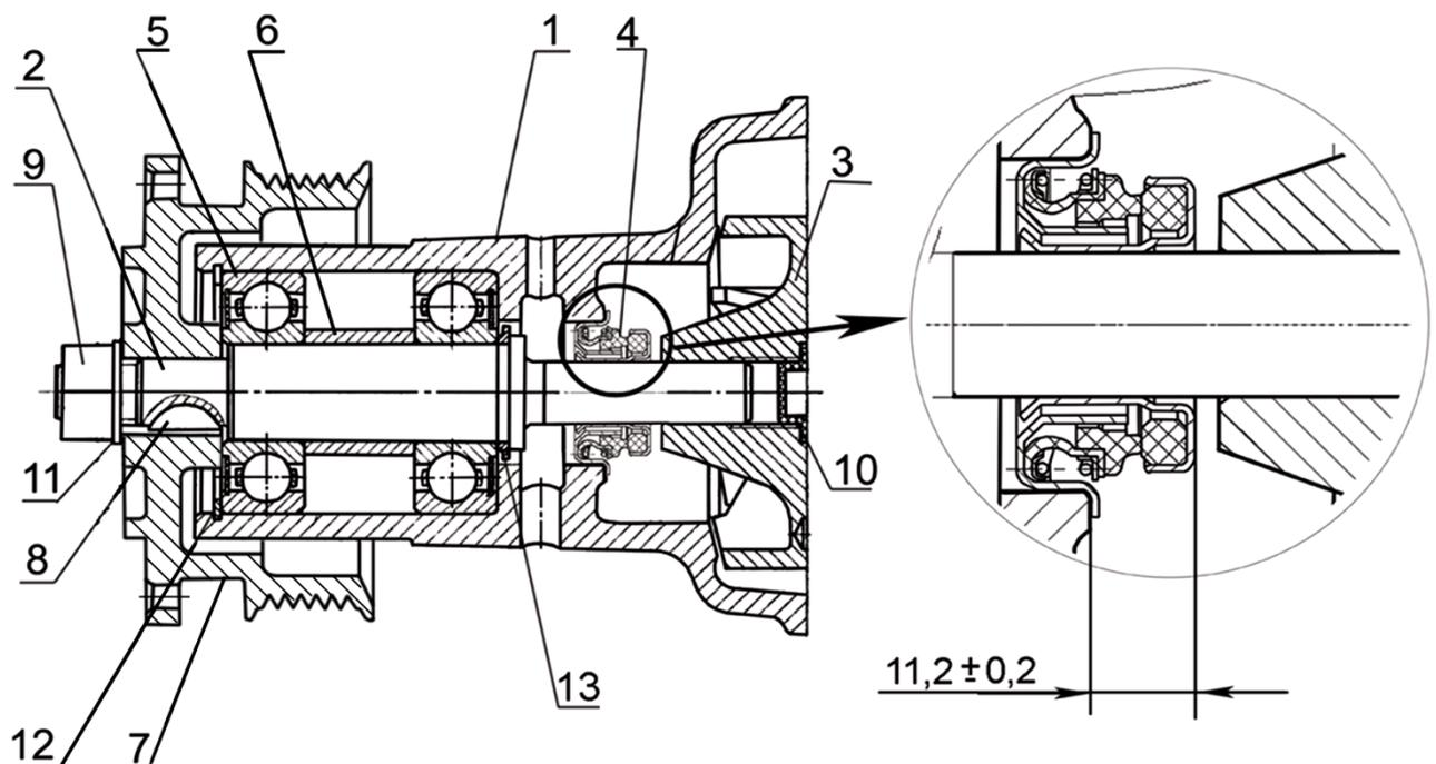
1 – корпус; 2 – валик насоса; 3 – крыльчатка; 4 – уплотнение водяного насоса SP/1341; 5 – подшипник; 6 – втулка; 7 – шкив; 8 – шпонка; 9 – гайка; 10 – заглушка; 11 – шайба; 12 – кольцо стопорное; 13 – кольцо упорное.
