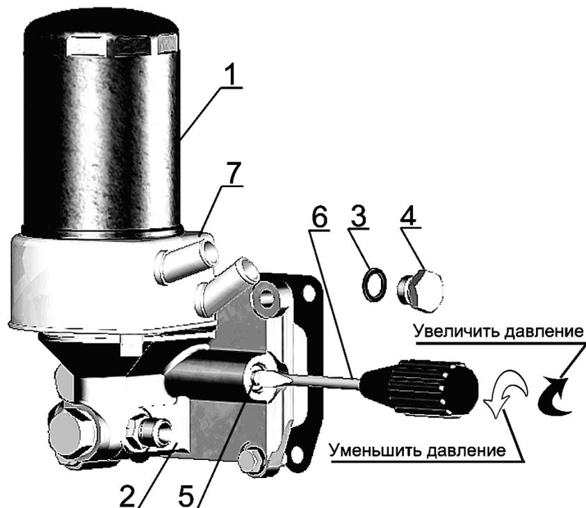
1 – фильтр масляный; 2 – корпус масляного фильтра; 3 – прокладка пробки; 4 – пробка редукционного клапана; 5 – пробка регулировочная; 6 – отвертка; 7 - мидкостно-масляный теплообменник;
