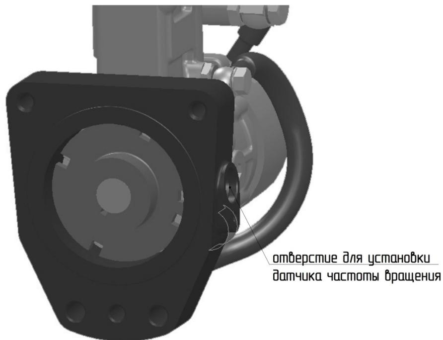
Рисунок 4 – Установка датчика частоты вращения ТНВД
