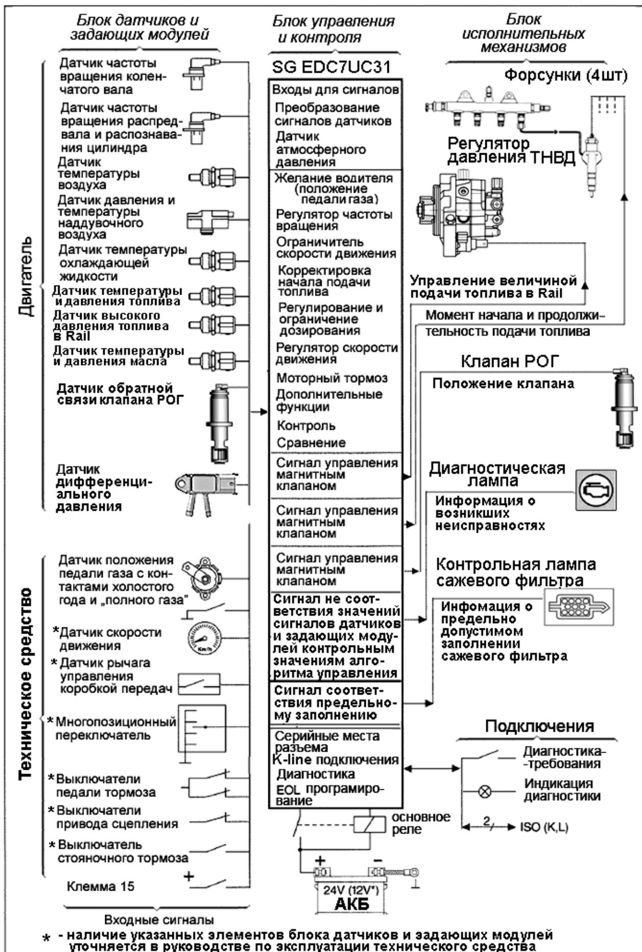
Рисунок 12 – устройство электронного управления работой двигателя.
