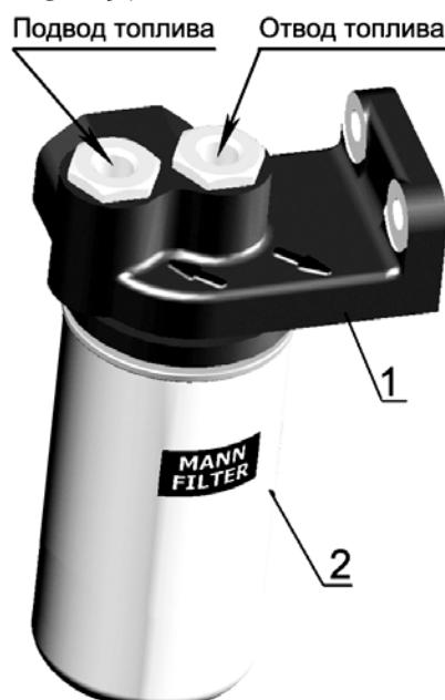
1 – корпус фильтра; 2 – фильтр тонкой очистки топлива Mann & Hummel WDK962
