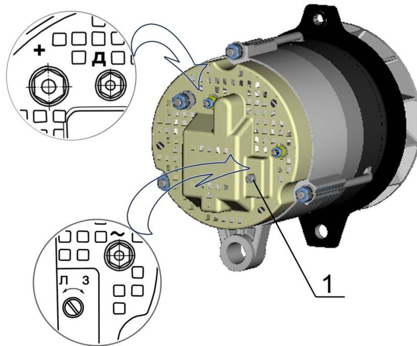
1 - винт посезонной регулировки напряжения.
