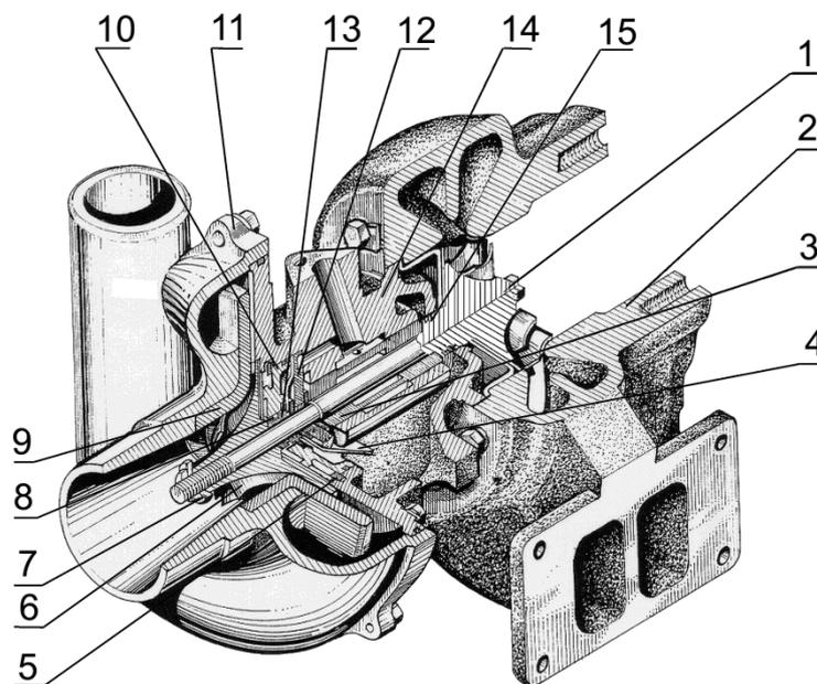
1 - колесо турбины с валом; 2 - корпус турбины; 3 - подшипник; 4 - маслоотражатель; 5-кольцо эксцентрическое; 6 - колесо компрессора; 7 - гайка специальная; 8, 15 –уплотнительные кольца; 9 - диффузор; 10 - крышка; 11 - корпус компрессора; 12 –упорный подшипник; 13 – втулка распорная; 14 - корпус подшипников.
