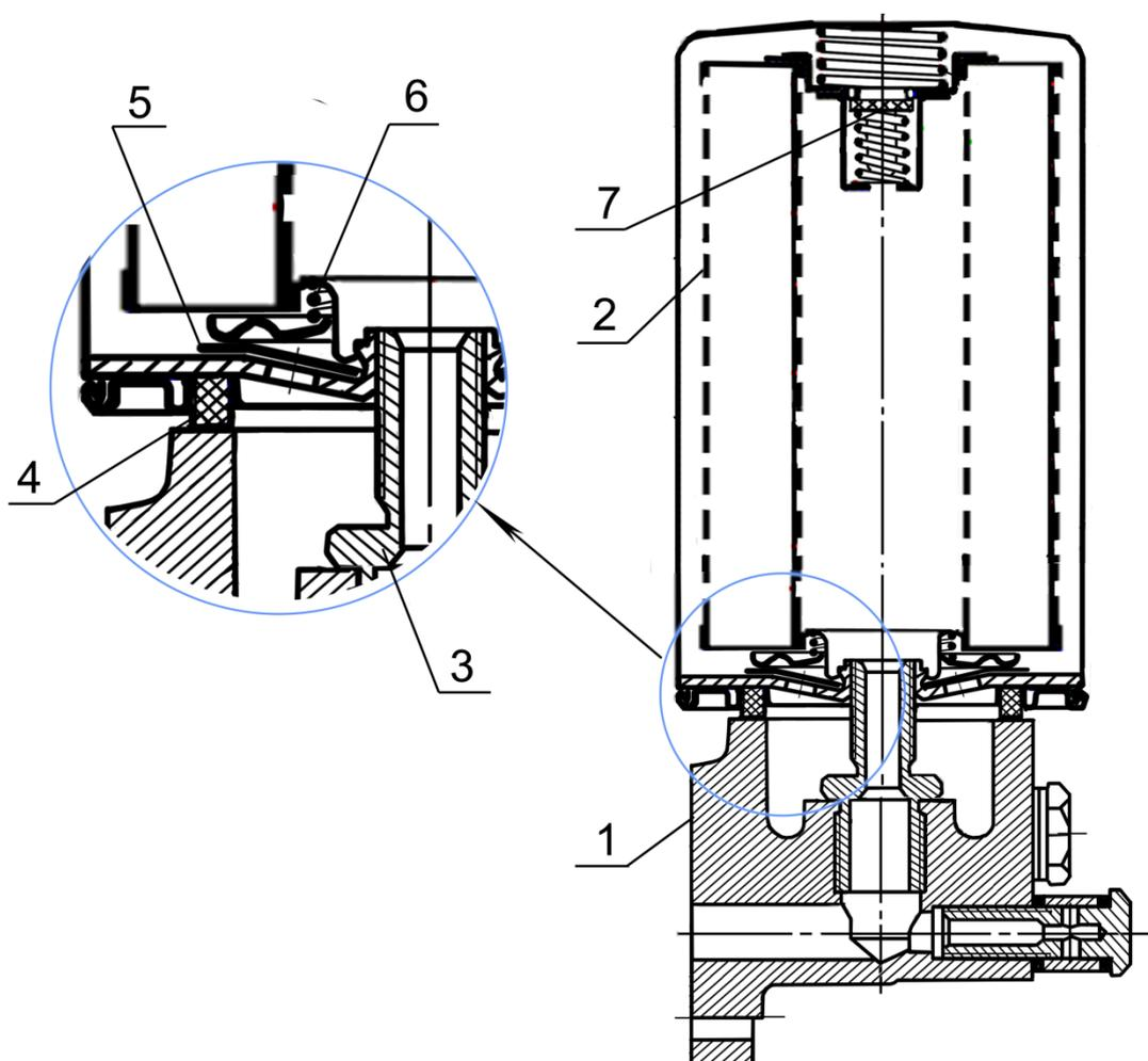
1 – корпус фильтра; 2 – фильтр; 3 – штуцер; 4 – прокладка фильтра; 5 – клапан противодренажный;
