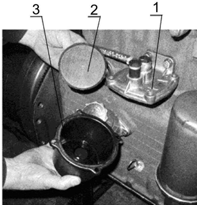
1 - корпус фильтра; 2 - отражатель с сеткой; 3 - стакан
