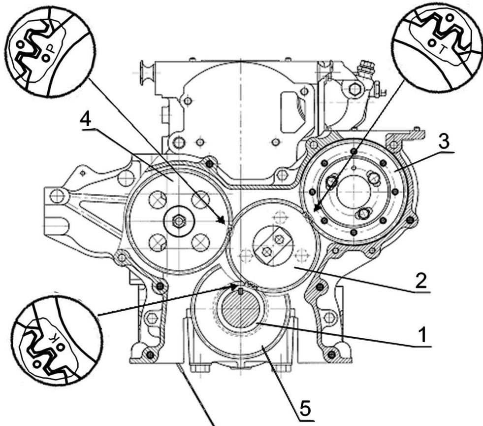
1-шестерня коленчатого вала; 2 - промежуточная шестерня; 3- шестерня привода топливного насоса;
