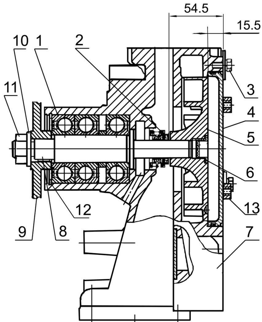
1-подшипник; 2-сальник водяного насоса; 3-болт; 4-крышка; 5-крыльчатка; 6-заглушка; 7-корпус;
