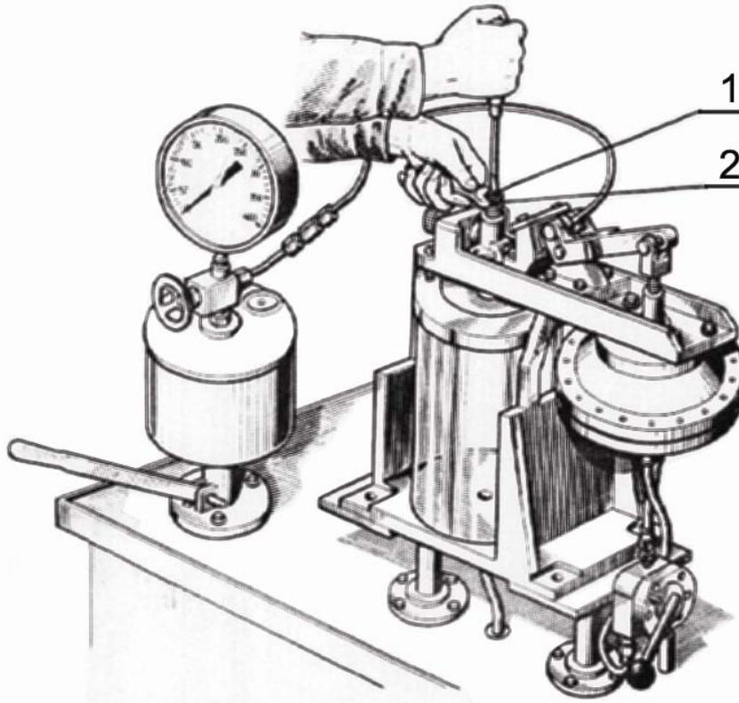
1 – винт регулировочный; 2 – гайка контрольная
