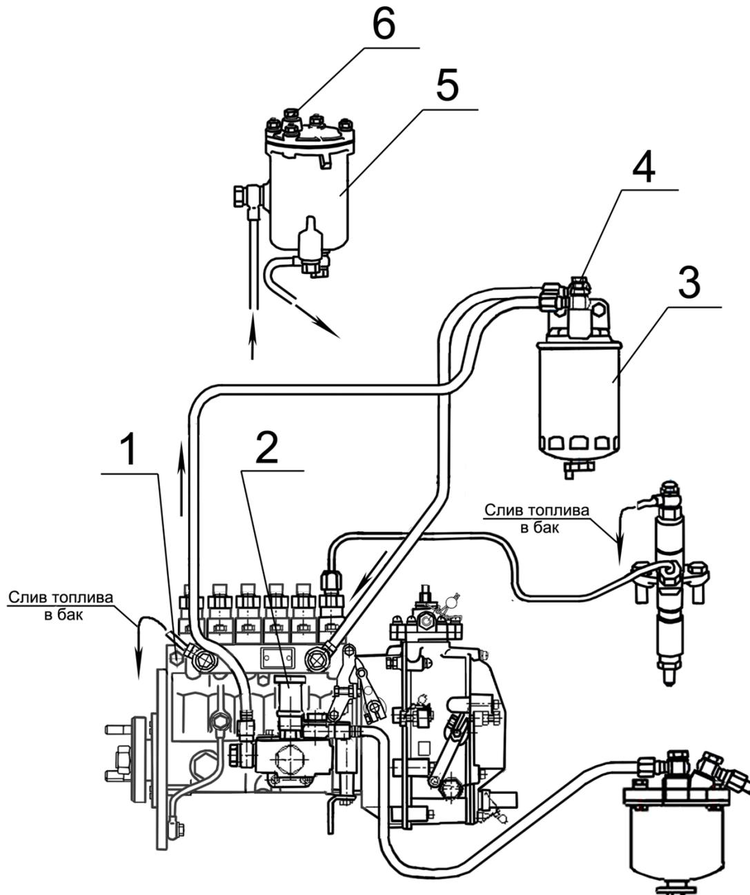
1- пробка (для выпуска воздуха); 2 - насос подкачивающий; 3 – фильтр топливный неразборный; 4 – пробка; 5 – фильтр топливный разборный; 6 – пробка.
