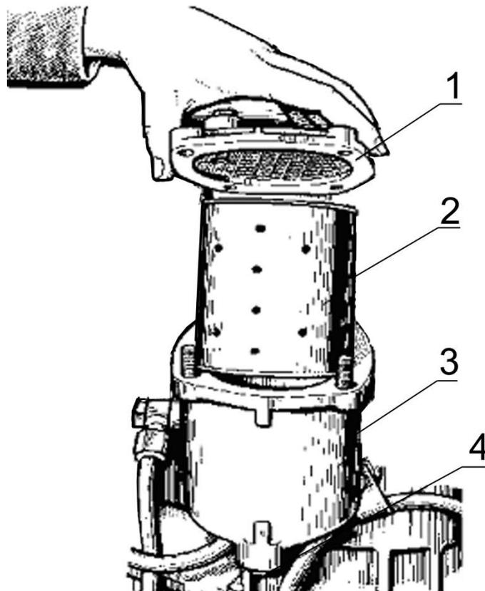
1 - крышка фильтра; 2 - элемент фильтрующий; 3 - корпус фильтра; 4 - пробка.
