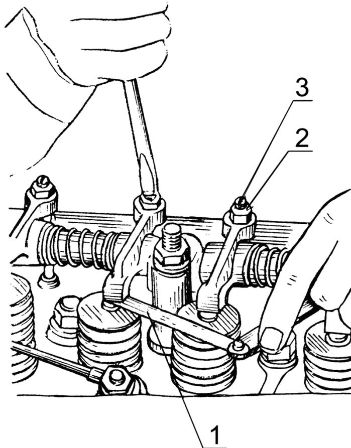
1 – щуп; 2- контргайка; 3 – регулировочный винт
