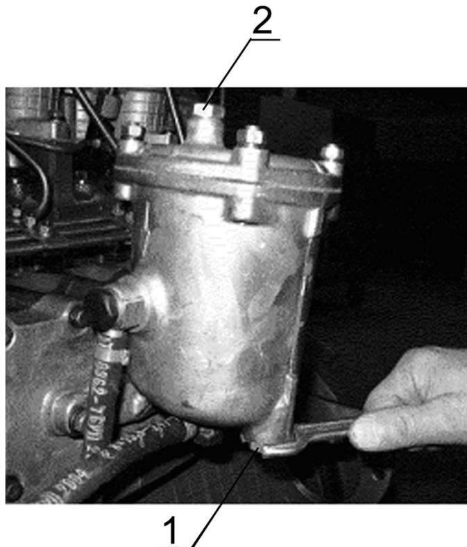
Рисунок 16– Слив отстоя из фильтра тонкой очистки топлива.
