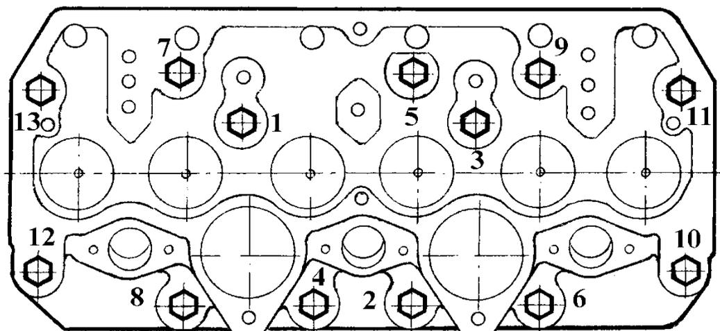
Рисунок 21- Схема последовательности затяжки болтов
