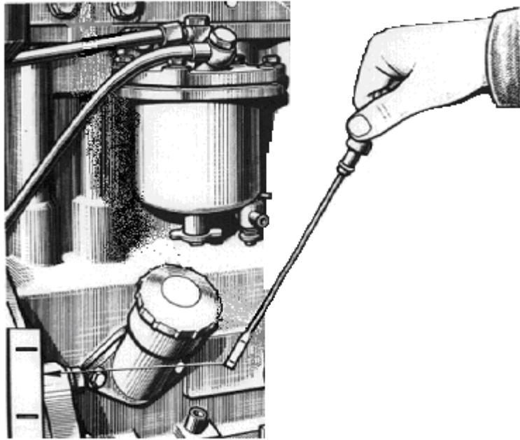
Рисунок 11- Проверка уровня масла в картере дизеля.
