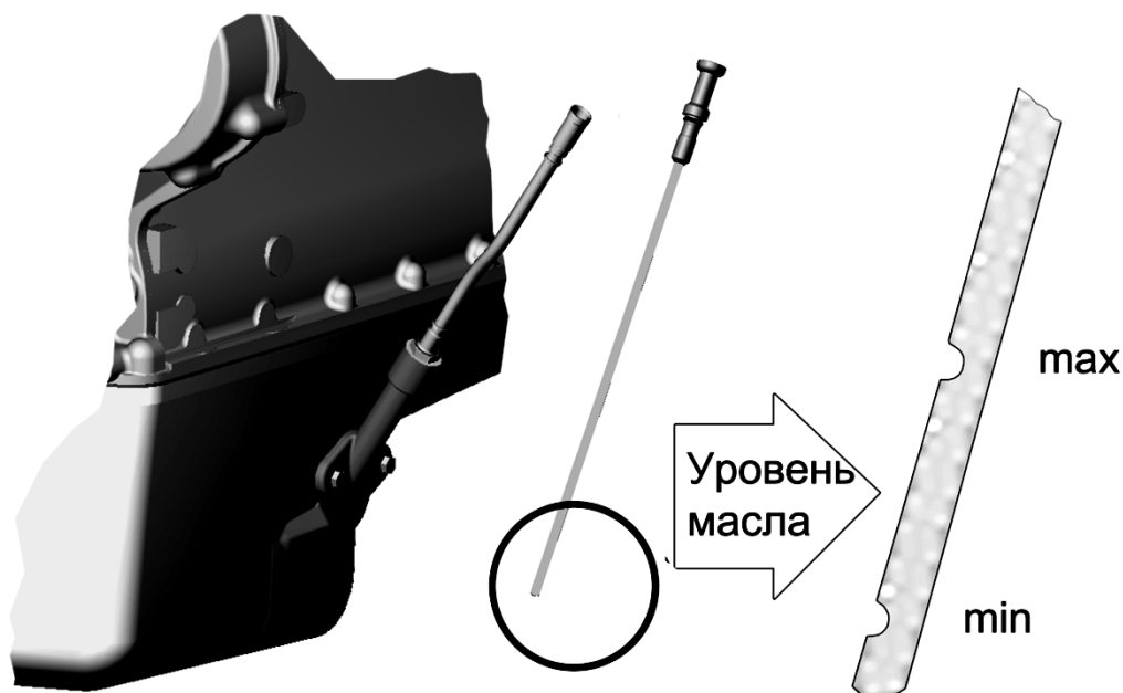
Рисунок 19- Проверка уровня масла в картере дизеля.
