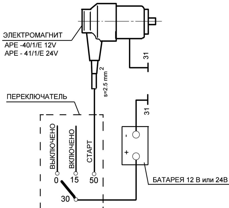
Рисунок 1.4 – Рекомендуемая схема включения пускового электромагнита.
