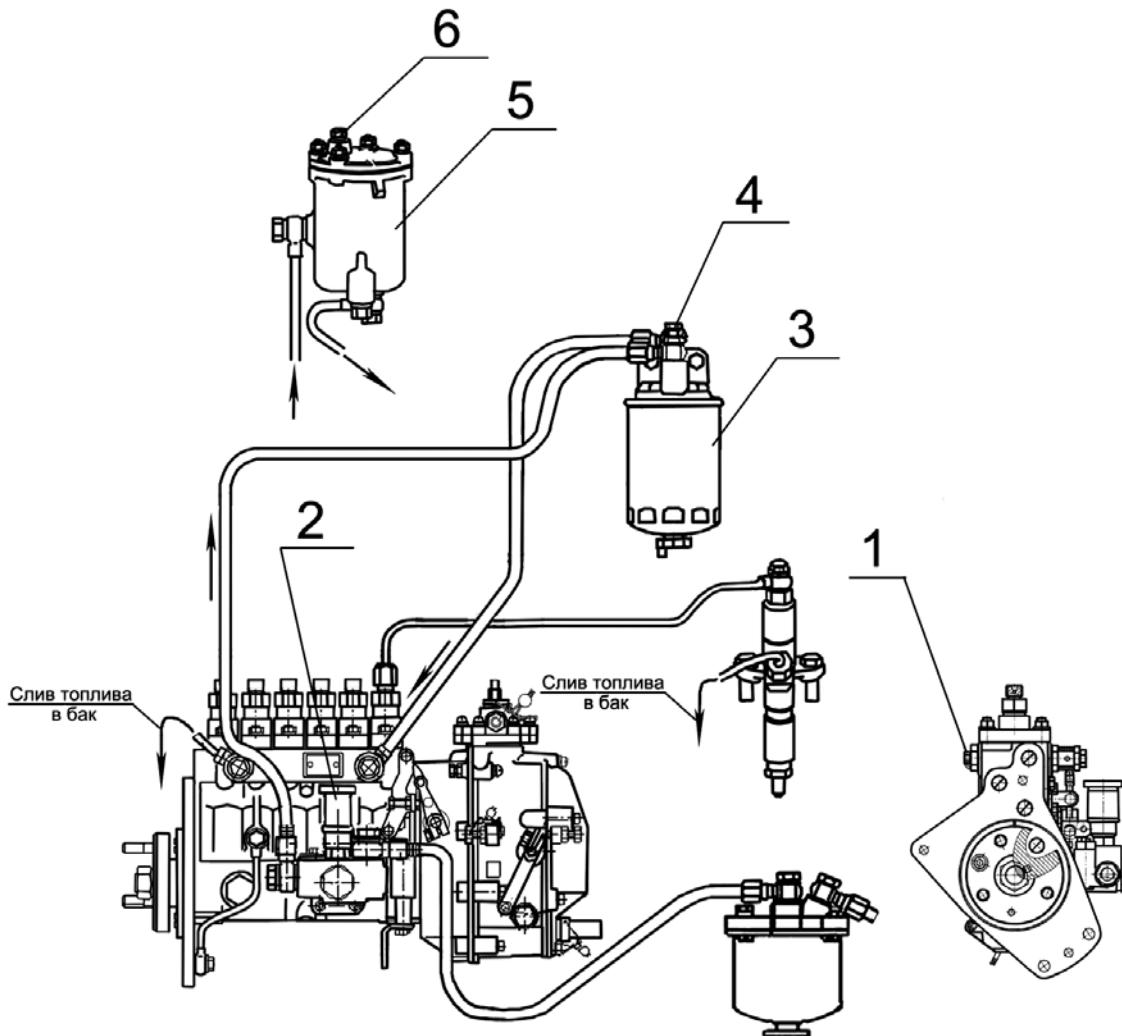
1 – пробка (для выпуска воздуха); 2 – насос подкачивающий; 3 – фильтр топливный неразборный; 4 – пробка; 5 – фильтр топливный разборный; 6 – пробка.
