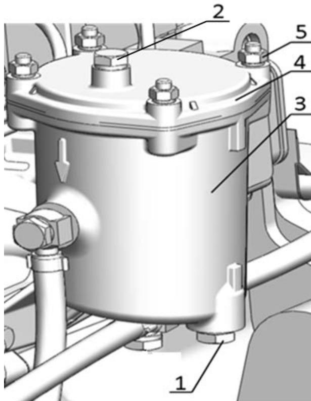
1 – пробка слива отстоя; 2 – пробка выпуска воздуха. 3 – корпус фильтра; 4 – крышка фильтра; 5 – гайка крепления крышки
