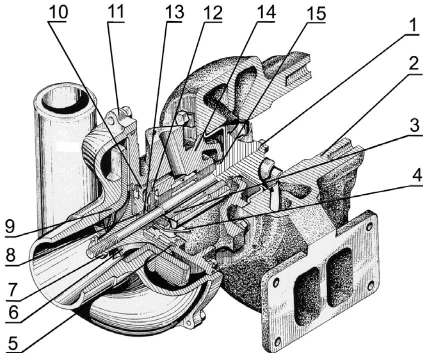
1 – колесо турбины с валом; 2 – корпус турбины; 3 – моновтулка; 4 – маслоотражатель; 5 – кольцо эксцентрическое; 6 – колесо компрессора; 7 – гайка специальная; 8, 15 –уплотнительные кольца; 9 – диффузор; 10 – крышка; 11 – корпус компрессора; 12 –упорный подшипник; 13 –втулка распорная; 14 –корпус средний.
