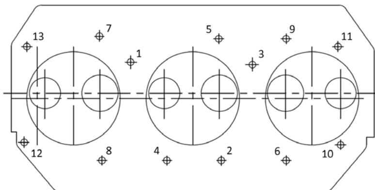
Рисунок 4.2 – Последовательности затяжки болтов крепления головки цилиндров.
