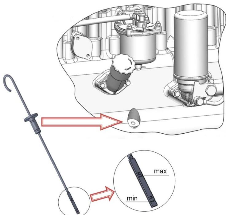
Рисунок 3.1 – Проверка уровня масла в картере дизеля.
