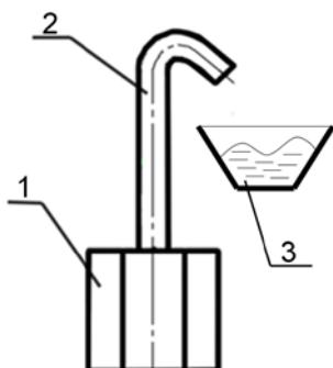
1 – нажимная гайка; 2 – топливопровод высокого давления; 3 – емкость.
