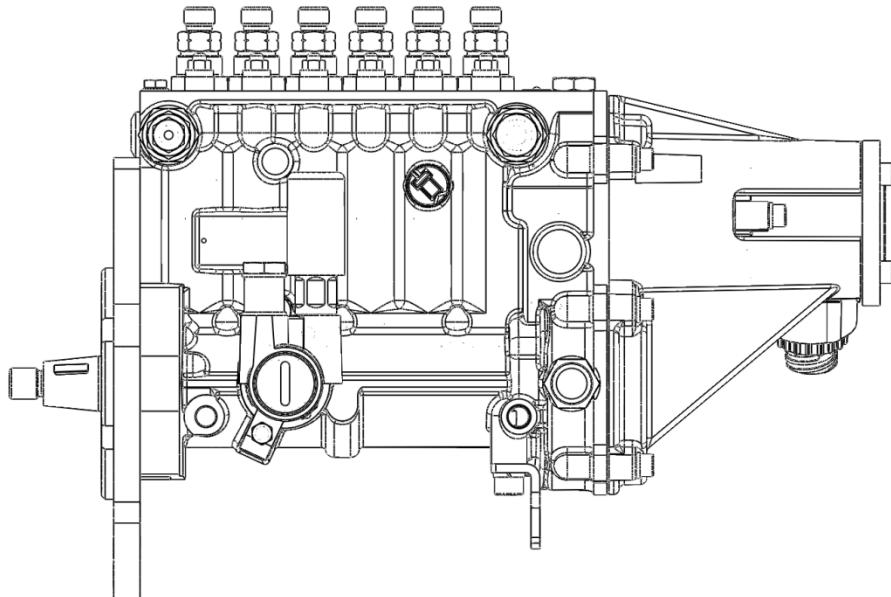
Рисунок 1.7 – Топливный насос высокого давления PP4M10Pl с электронным регулятором (фирмы «Моторпал», Чехи).
