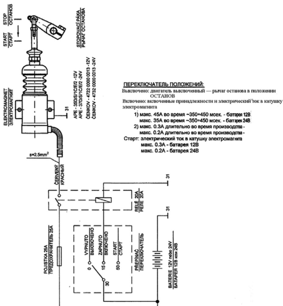
Рисунок 1.8 – Схема включения электромагнита останова.
