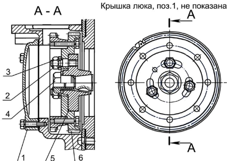
1 – крышка люка; 2 – гайка; 3 – шпилька; 4 – гайка специальная; 5 – фланец привода; 6 – шестерня привода топливного насоса.
