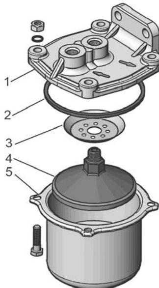
1 – корпус фильтра; 2 – кольцо; 3 – рассеиватель; 4 – отражатель с сеткой; 5 – стакан.
