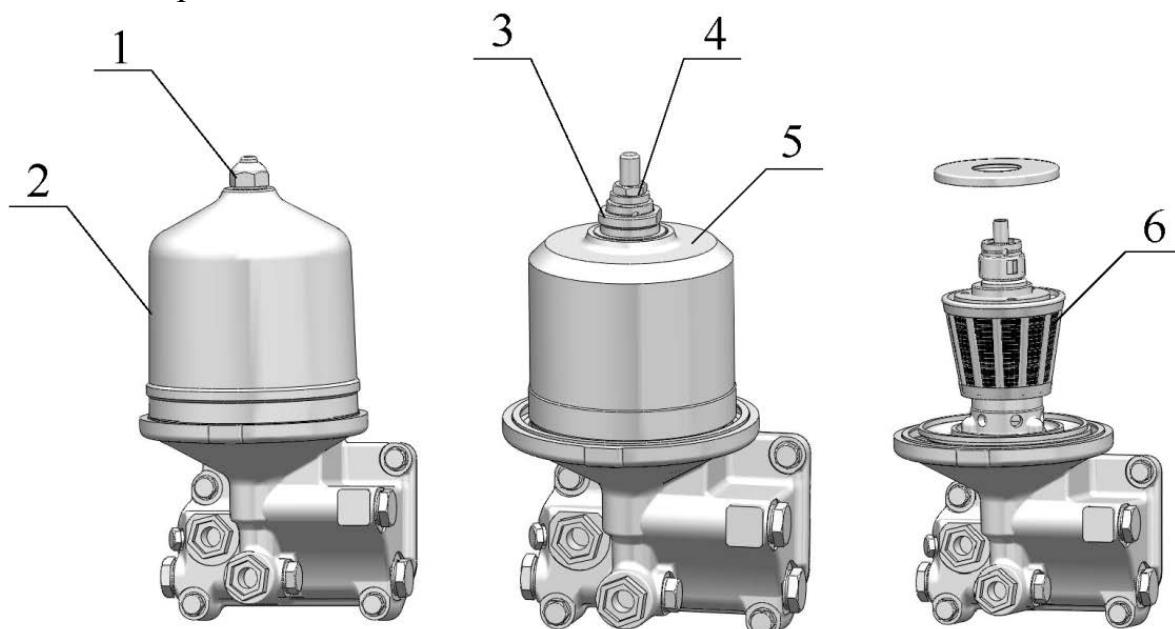
Рисунок 3.5 – Очистка ротора центробежного масляного фильтра.
