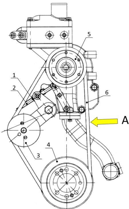
1 – контргайка; 2 – палец; 3 – ролик; 4 – шкив коленчатого вала; 5 – шкив водяного насоса; 6 – ремень; 7 – шкив компрессора.
