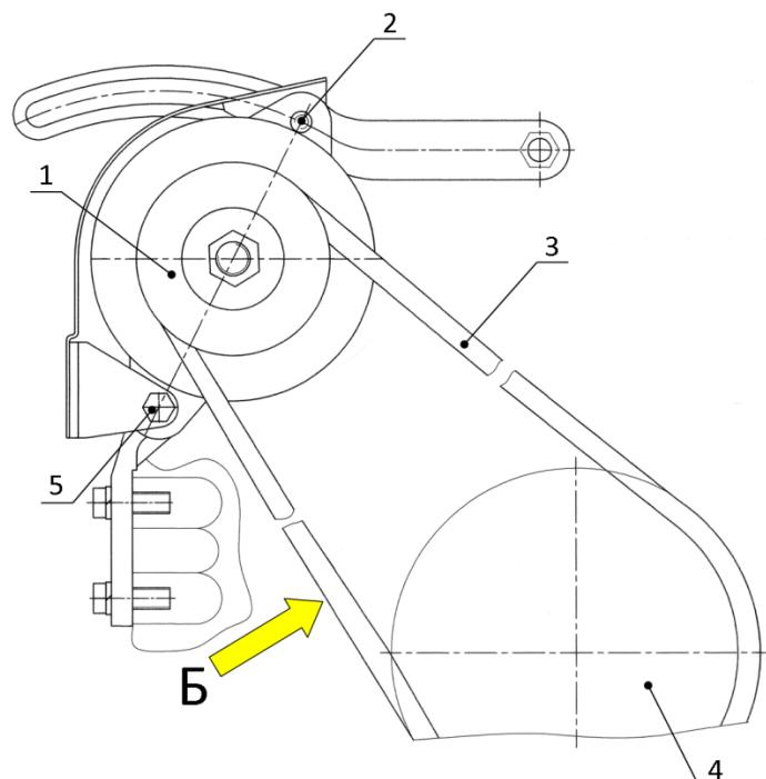
1 – шкив генератора; 2 – болт крепления; 3 – ремень; 4 – шкив коленчатого вала; 5 – болт крепления кронштейна генератора.
