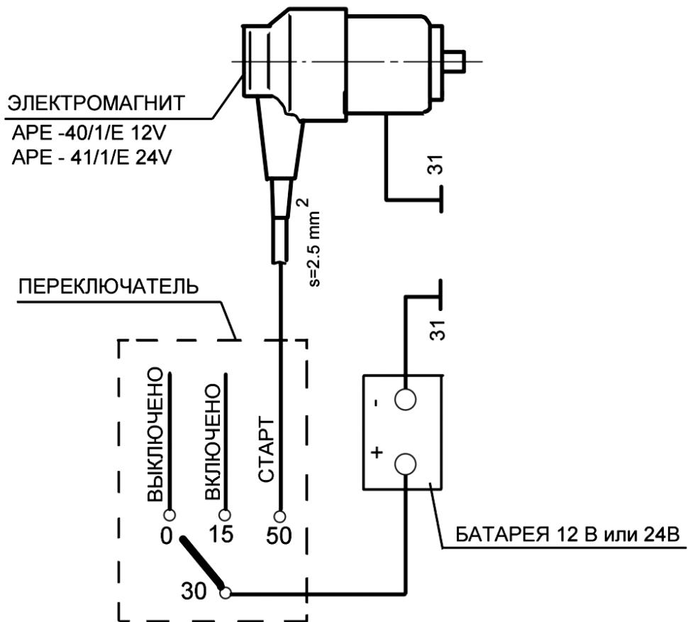
Рисунок 1.9 – Схема включения пускового электромагнита.
