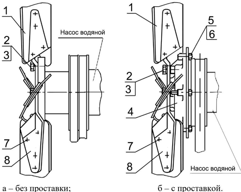
1 – лопасть, 2 – болт, 3 – шайба, 4 – проставка, 5 – болт, 6 – шайба, 7 – заклепка, 8 – крестовина.
