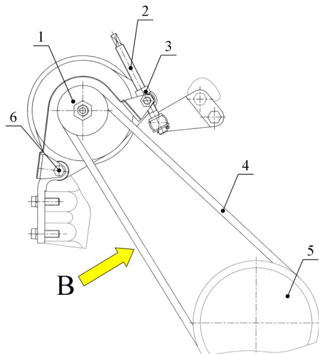
1 –шкив генератора; 2 – палец; 3 – контргайка; 4 –ремень; 5 – шкив коленчатого; 6 – болт крепления кронштейна генератора.
