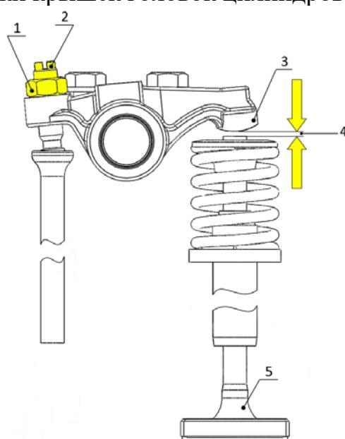
1 – контргайка; 2 – винт регулировочный; 3 – боец коромысла; 4 – зазор; 5 – клапан.
