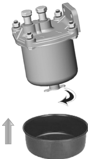
Рисунок 27 – Слив отстоя из фильтра топливного грубой очистки.
